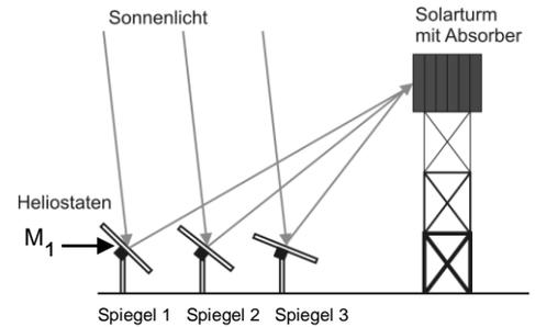
An Spiegel 2 wird der Sonnenstrahl so reflektiert, dass der reflektierte Strahl durch die Gerade
